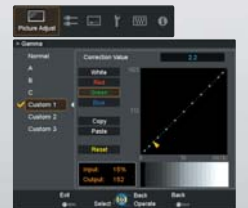
Die anwenderspezifische Gammakorrektur erfolgt über komfortable Video-Einstellmenüs.
